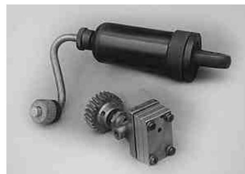
Bomba de engrenagem usada para forçar a Viscose para os orifícios das feieiras
