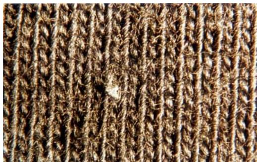
**Figura 7 Defeito de pontos brancos na malha**
