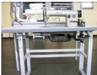
**Figura 6: Máquina Reta Ponto Fixo Convencional Adaptada**
