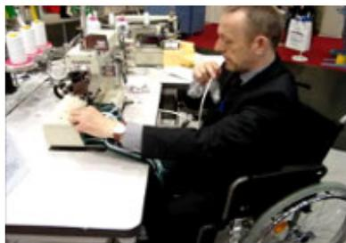
**Figura 5: Máquina com acionamento por sopro – Kansai**
