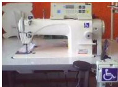
**Figura 3: Máquina de costura eletrônica para cadeirante - Willmak**
