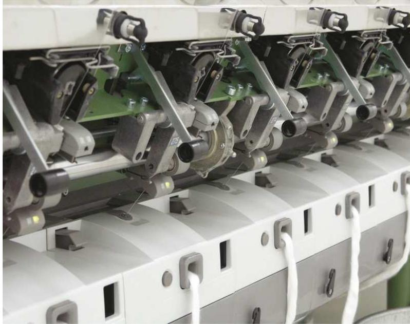
Filatório a rotor (open end).IMAGEM.19.3
