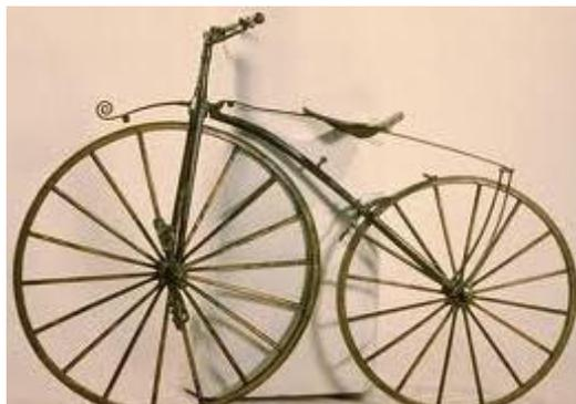
Figura 5 – Velocípede com pedais na roda da frente; [5]
