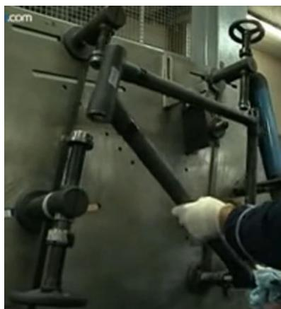
Figura 28 – Estrutura montada no gabari.
