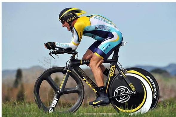
Figura 9 – Bicicleta de corrida com quadro em fibra de carbono; [10]
