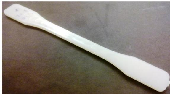
Figura 2.3.1 – Provete utilizado no ensaio;
