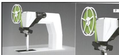
**Xi'na Typical** – Máquina Vetron® de solda com sistema de ar quente que consome menos energia.
