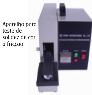
Aparelho para teste de solidez de cor à fricção
