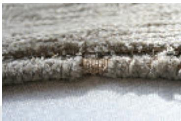
Tecido desgastado pelo uso de cordão em posição inadequada. A modelagem, a costura mal posicionada, a combinação com aviamentos, etc podem gerar um desgaste acelerado pela abrasão em determinadas partes do estofado.
