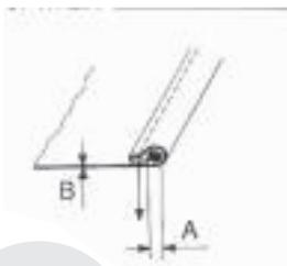
Aparelho para colocação de cordão, útil para acabamento em barra de cortinas e para fechamento de estofados.
