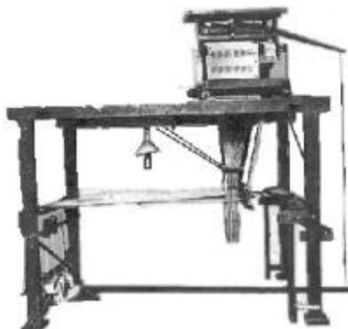
Em 1979, a BONAS MACHINE COMPANY da Inglaterra desenvolveu o primeiro seletor eletrônico (figura 2) para substituição dos cartões e papéis perfurados, agulhas, alavancas, molas e sistemas mecânicos de seleção de platinas/ganchos da máquina jacquard.
